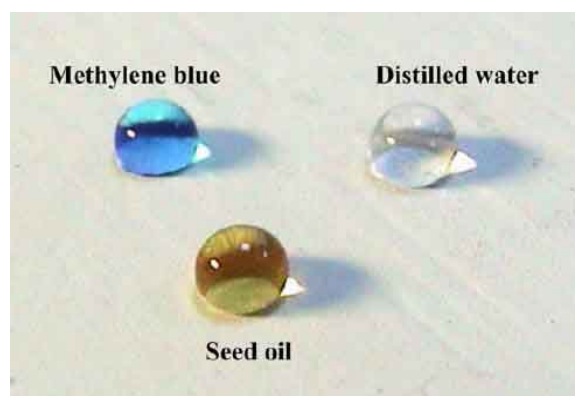
Рис. 3.9. Покрытие на основе наночастиц оксида титана: а) структура поверхности, б) смачиваемость цементной плиты с покрытием растительным маслом, дистиллированной водой и спиртовым раствором [52].
