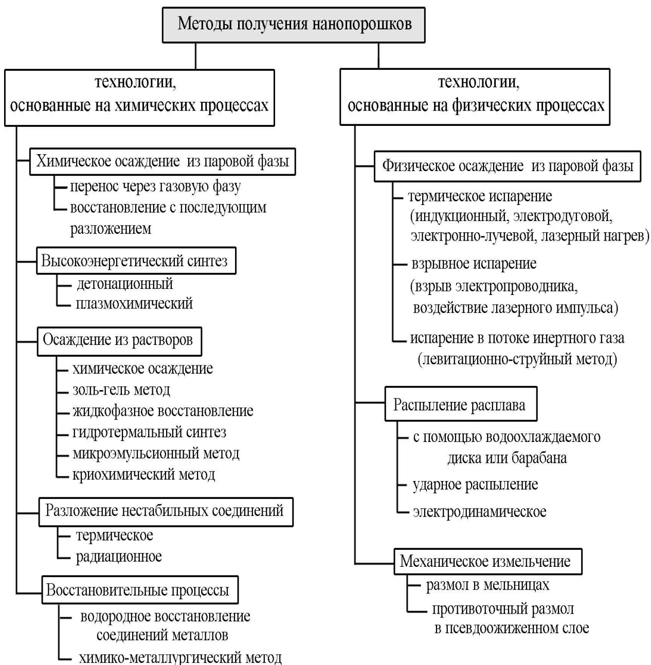
Рис. 4.2. Основные из используемых в настоящее время методов получения нанопорошков
