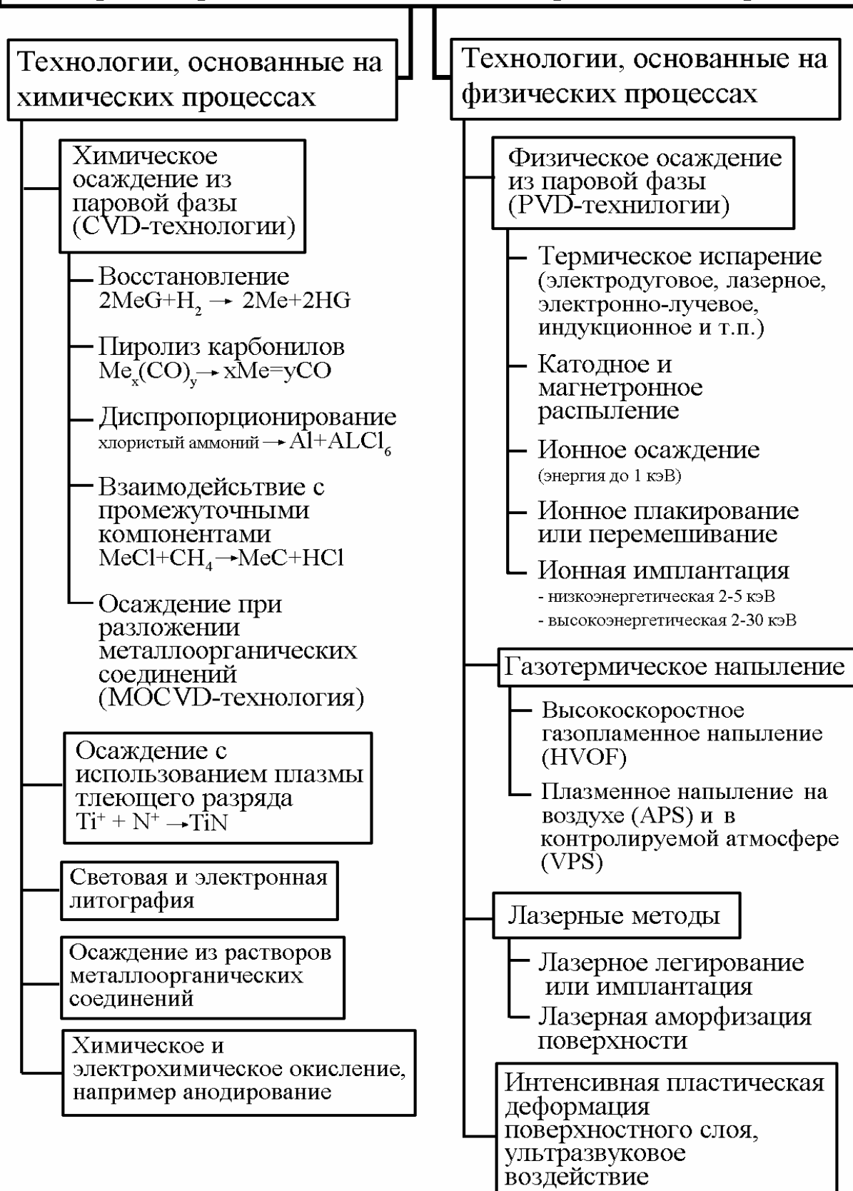
Рис. 4.16. Примерная классификационная схема наноориентированных технологий обработки поверхности
