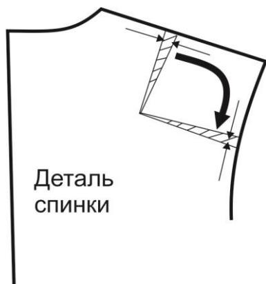
Поскольку фактическое значение (1,5 см) превышает допустимое (0,78 см), то следует провести уменьшение угла сутюживания за счет частичного перераспределения в линию горловину или пройму (рис.8).
