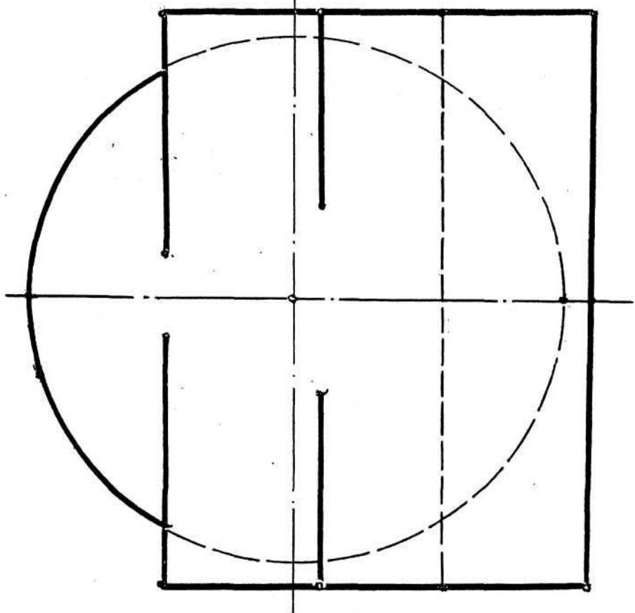
Построить линию пересечения проецирующей плоскости  $\gamma$  с плоскостью общего положения  $\alpha (m \parallel n)$
