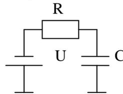
Разработать схему для численного моделирования процессов зарядки.
