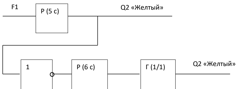
Рис. 20. Сигнал «Горит-Мигает» с двумя выходами
