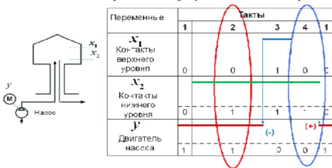
Рис. 27 Принципиальная схема водонапорной башни и циклограмма работы подающего насоса
