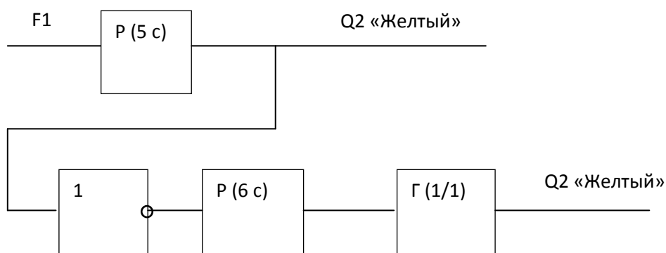
Рис. 20. Сигнал «Горит-Мигает» с двумя выходами
