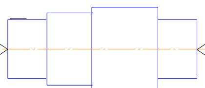
3. Плавающий передний, вращающийся задний центр и поводковый патрон.
