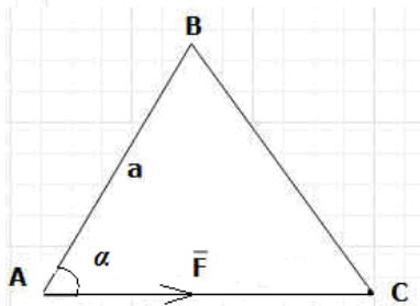
Задание 3. Определить момент силы  $F$ , приложенной к точке А треугольной пластины, относительно точки С, если  $F=7 \text{ кН}$ ,  $a=8 \text{ м}$ ,  $\alpha=30^\circ$ .
