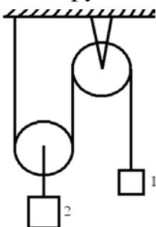
13. Два груза подвешены к системе, состоящей из двух блоков, как показано на рисунке. Груз 1 поднимается со скоростью 4 м/с. Определить, поднимается или опускается груз 2 и найти его скорость.
