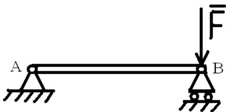
3. На балку, изображенную на рисунке, действует сила  $F$ , равная 10 кН. Чему равна реакция в шарнире A?
