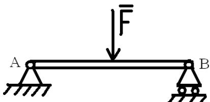
4. На балку, изображенную на рисунке, действует сила  $F$ , равная 10 кН. Чему равна реакция в шарнире B?
