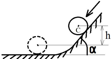
22. Сплошной однородный диск массы  $m$  и радиуса  $r$  толкнули вверх по гладкой наклонной плоскости как показано на рисунке. Определить с какой скоростью нужно толкнуть диск, чтобы пройденный путь до остановки был равен  $s=0,3\text{м}$ . Угол  $\alpha=30$ , ускорение свободного падения  $g=9,8 \text{ м/с}^2$ .
