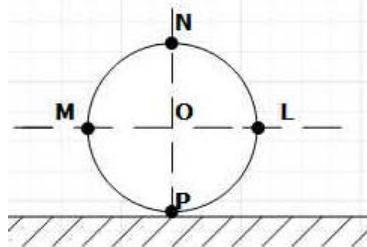
Задание 18. Колесо радиуса  $R=9\text{ м}$  катится без скольжения по неподвижной прямой. Скорость центра  $v_0 = 5\sqrt{2} \frac{\text{м}}{\text{с}}$ . Определить скорость точки  $L$  обода колеса в данный момент времени.
