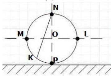
Задание 20. Колесо радиуса  $R=3$  м катится без скольжения по неподвижной прямой. Скорость центра  $v_0 = 3 \frac{м}{с}$ . Определить скорость точки  $N$  обода колеса в данный момент времени.
