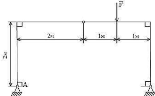
Задание 30. Определить модуль силы  $F$ , уравновешивающей пару сил с моментом  $M$ , если  $AB = 3$  м. Весом конструкции и трением в шарнирах пренебречь.
