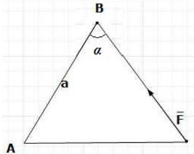
Задание 6. Определить момент силы  $F$ , приложенной к точке В треугольной пластины, относительно точки С, если  $F=4 \text{ кН}$ ,  $a=10 \text{ м}$ ,  $\alpha=30^\circ$ .
