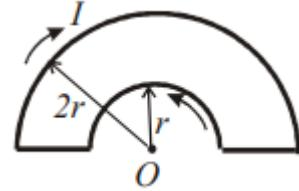
Ток  $I = 10$  А течет по плоскому контуру из тонкого провода, показанному на рисунке. Магнитная индукция в центре петли равна ... мкТл. Среда – вакуум. Ответ округлите до целых,
