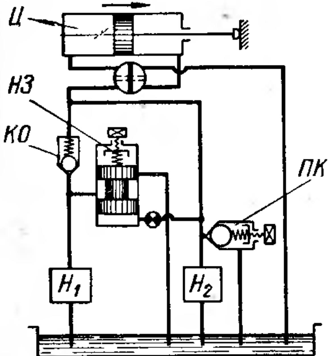
Ц – цилиндр, НЗ – напорный золотник, Н1 – насос низкого давления (большой производительности) Н2 – насос высокого давления (малой производительности), КО – обратный клапан, ПК – предохранительный клапан
