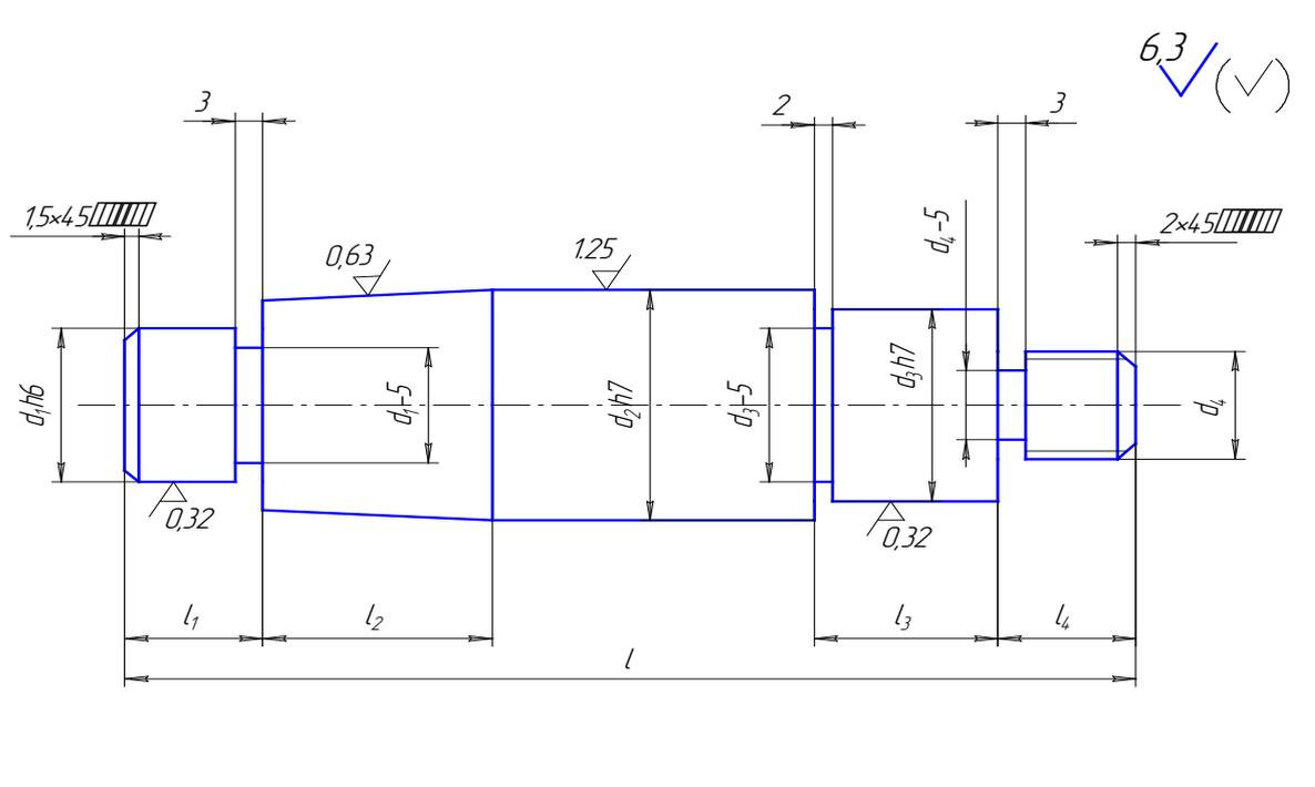
Рис. 1. Типовая деталь.
