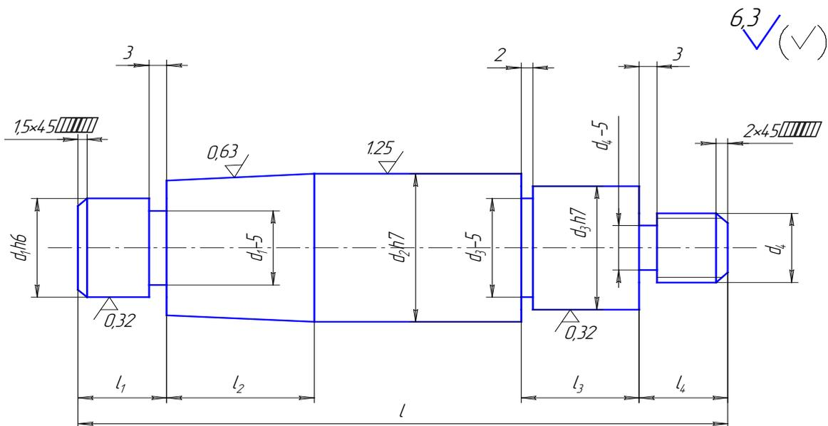
Рис. 1. Типовая деталь.
