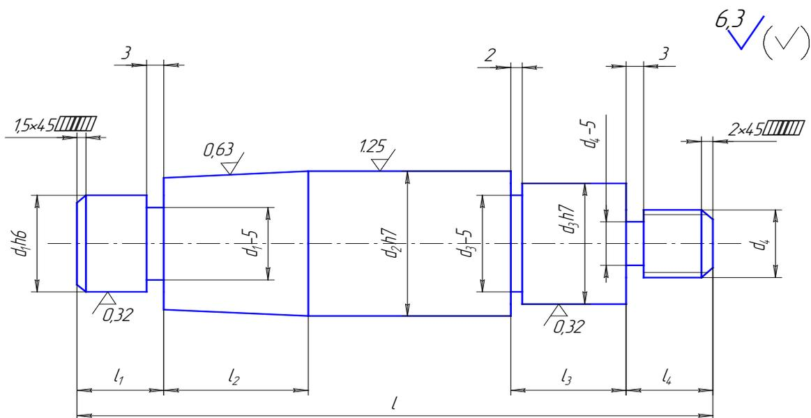
Рис. 1. Типовая деталь.
