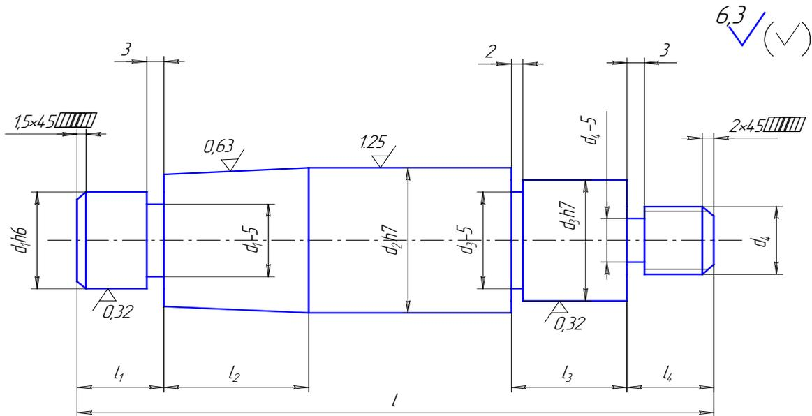
Рис. 1. Типовая деталь.
