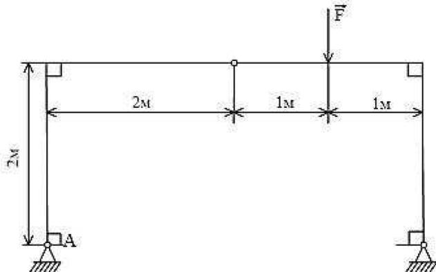
Задание 30. Определить модуль силы  $F$ , уравновешивающей пару сил с моментом  $M$ , если  $AB = 3$  м. Весом конструкции и трением в шарнирах пренебречь.
