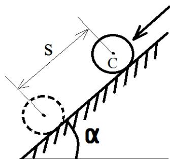
21. Сплошной однородный диск массы  $m$  и радиуса  $r$  скатывается вниз по гладкой наклонной плоскости как показано на рисунке. Определить с какой высоты  $h$  нужно пустить диск без начальной скорости, чтобы скорость его центра в нижнем
