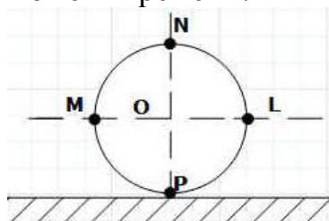
Задание 19. Колесо радиуса  $R=6\text{ м}$  катится без скольжения по неподвижной прямой. Скорость центра  $v_0 = 10 \frac{\text{м}}{\text{с}}$ , угол  $PNK$  равен  $30^\circ$ . Определить скорость точки  $K$  обода колеса в данный момент времени.
