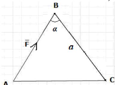
Задание 4. Определить момент силы  $F$ , приложенной к точке С треугольной пластины, относительно точки В, если  $F=3 \text{ кН}$ ,  $a=6 \text{ м}$ ,  $\alpha=30^\circ$ .
