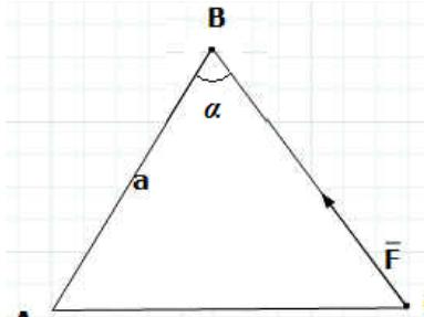
Задание 6. Определить момент силы  $F$ , приложенной к точке В треугольной пластины, относительно точки С, если  $F=4 \text{ кН}$ ,  $a=10 \text{ м}$ ,  $\alpha=30^\circ$ .
