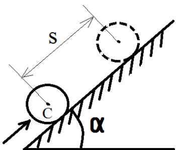
23. Сплошной однородный диск массы  $m$  и радиуса  $r$  толкнули вверх по гладкой наклонной плоскости со скоростью  $v_C=1,4\text{ м/с}$  как показано на рисунке. Определить на какую высоту  $h$  поднимется тело до остановки. Угол  $\alpha=30$ , ускорение свободного падения  $g=9,8 \text{ м/с}^2$ .
