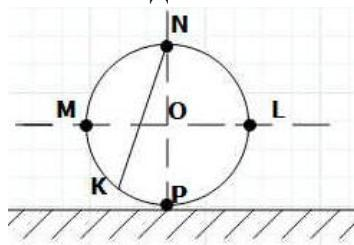
Задание 20. Колесо радиуса  $R=3$  м катится без скольжения по неподвижной прямой. Скорость центра  $v_0 = 3 \frac{m}{s}$ . Определить скорость точки  $N$  обода колеса в данный момент времени.
