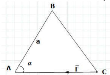
Задание 5. Определить момент силы  $F$ , приложенной к точке С треугольной пластины, относительно точки А, если  $F=5 \text{ кН}$ ,  $a=4 \text{ м}$ ,  $\alpha=30^\circ$ .
