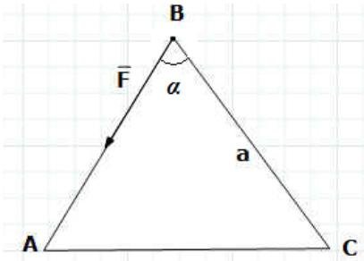
Задание 7. Определить момент силы  $F$ , приложенной к точке В треугольной пластины, относительно точки А, если  $F=2\text{kH}$ ,  $a=8\text{м}$ ,  $\alpha=30^\circ$ .
