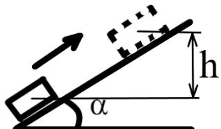
20. Сплошной однородный диск массы  $m$  и радиуса  $r$  скатывается вниз по гладкой наклонной плоскости без начальной скорости как показано на рисунке. Определить скорость центра диска в момент времени, когда пройденный путь станет равен  $s=0,3\text{м}$ . Угол  $\alpha=30^\circ$ , ускорение свободного падения  $g=9,8 \text{ м/с}^2$ .
