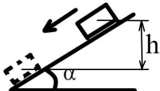
18. Тело массы  $m$  толкнули вверх по гладкой наклонной плоскости как показано на рисунке. Определить начальную скорость тела, если пройденный путь до остановки равен  $s=0,2\text{м}$ . Угол  $\alpha=30^\circ$ , ускорение свободного падения  $g=9,8 \text{ м/с}^2$ .
