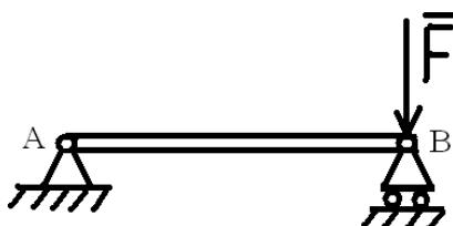
2. На балку, изображенную на рисунке, действует сила  $F$ , равная 10 кН. Чему равна реакция в шарнире B?
