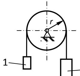
Задание 3. Кинетический потенциал системы, выраженный через ее обобщенную координату  $u$  и обобщенную скорость  $\dot{u}$ , равен  $L = \dot{u}^2 + 2u$ . Определите ускорение  $\ddot{u}$ .
