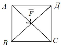
Задание 9. Определить момент силы  $F$ , приложенной к вершине В квадратной пластины, относительно точки А, если  $F=80\text{Н}$ ,  $AC=0,4\text{м}$ .
