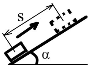
19. Тело массы  $m$  толкнули вверх по гладкой наклонной плоскости со скоростью  $v=1,4\text{ м/с}$  как показано на рисунке. Определить на какую высоту  $h$  поднимется тело до остановки. Угол  $\alpha=30^\circ$ , ускорение свободного падения  $g=9,8 \text{ м/с}^2$ .
