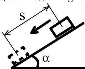
17. Тело массы  $m$  начинает скользить вниз по гладкой наклонной плоскости без начальной скорости как показано на рисунке. Определить на какую высоту  $h$  опустится тело, когда его скорость станет равна  $v=1,4\text{ м/с}$ . Угол  $\alpha=30^\circ$ , ускорение свободного падения  $g=9,8 \text{ м/с}^2$ .
