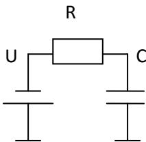
Разработать схему для численного моделирования процесса зарядки.
