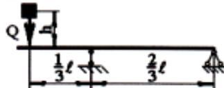
На двутавровую балку, свободно лежащую на двух жестких опорах, с высоты  $h$  падает груз весом  $Q$ . Требуется найти наибольшее динамическое нормальное напряжение в балке при ударе.
