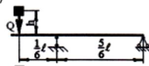
На двутавровую балку, свободно лежащую на двух жестких опорах, с высоты  $h$  падает груз весом  $Q$ . Требуется найти наибольшее динамическое нормальное напряжение в балке при ударе.
