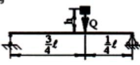
На двутавровую балку, свободно лежащую на двух жестких опорах, с высоты  $h$  падает груз весом  $Q$ . Требуется найти наибольшее динамическое нормальное напряжение в балке при ударе.
