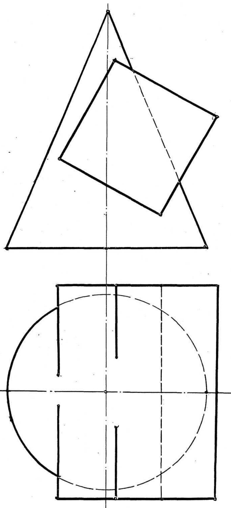
Построить линию пересечения проецирующей плоскости  $\gamma$  с плоскостью общего положения  $\alpha (m \parallel n)$
