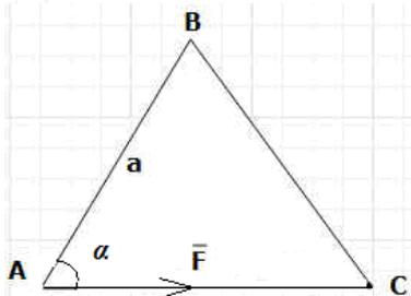
Задание 3. Определить момент силы  $F$ , приложенной к точке  $A$  треугольной пластины, относительно точки  $C$ , если  $F=7 \text{ кН}$ ,  $a=8 \text{ м}$ ,  $\alpha=30^\circ$ .
