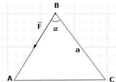
Задание 7. Определить момент силы  $F$ , приложенной к точке  $B$  треугольной пластины, относительно точки  $A$ , если  $F=2\text{кН}$ ,  $a=8\text{м}$ ,  $\alpha=30^\circ$ .
