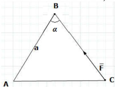
Задание 6. Определить момент силы  $F$ , приложенной к точке  $B$  треугольной пластины, относительно точки  $C$ , если  $F=4 \text{ кН}$ ,  $a=10 \text{ м}$ ,  $\alpha=30^\circ$ .
