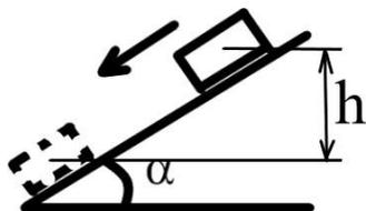
18. Тело массы  $m$  толкнули вверх по гладкой наклонной плоскости как показано на рисунке. Определить начальную скорость тела, если пройденный путь до остановки равен  $s=0,2\text{ м}$ . Угол  $\alpha=30$ , ускорение свободного падения  $g=9,8\text{ м/с}^2$ .
