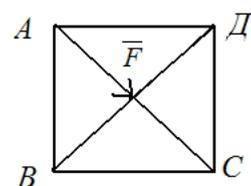
Задание 9. Определить момент силы  $F$ , приложенной к вершине  $B$  квадратной пластины, относительно точки  $A$ , если  $F=80\text{Н}$ ,  $AC=0,4\text{м}$ .
