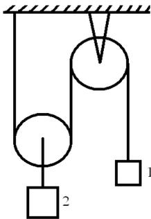
13. Два груза подвешены к системе, состоящей из двух блоков, как показано на рисунке. Груз 1 поднимается со скоростью 4 м/с. Определить, поднимается или опускается груз 2 и найти его скорость.
