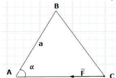
Задание 5. Определить момент силы  $F$ , приложенной к точке  $C$  треугольной пластины, относительно точки  $A$ , если  $F=5 \text{ кН}$ ,  $a=4 \text{ м}$ ,  $\alpha=30^\circ$ .
