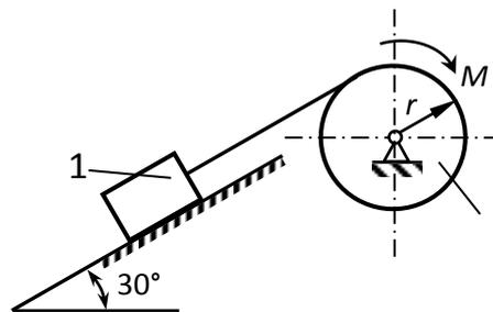
Задание 2. Грузы 1 и 2, массы которых  $m_2=2m_1$ , прикреплены к тросу, переброшенному через блок радиуса  $r$ . Пренебрегая массой блока, определите ускорение грузов.
