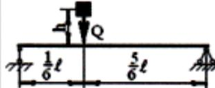
На двутавровую балку, свободно лежащую на двух жестких опорах, с высоты  $h$  падает груз весом  $Q$ . Требуется найти наибольшее динамическое нормальное напряжение в балке при ударе.
