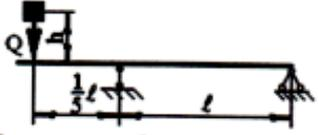
На двутавровую балку, свободно лежащую на двух жестких опорах, с высоты  $h$  падает груз весом  $Q$ . Требуется найти наибольшее динамическое нормальное напряжение в балке при ударе.
