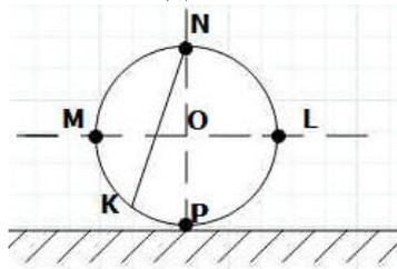
Задание 20. Колесо радиуса  $R=3$  м катится без скольжения по неподвижной прямой. Скорость центра  $v_0 = 3 \frac{m}{c}$ . Определить скорость точки  $N$  обода колеса в данный момент времени.
