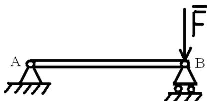
2. На балку, изображенную на рисунке, действует сила  $F$ , равная 10 кН. Чему равна реакция в шарнире В?
