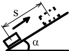
19. Тело массы  $m$  толкнули вверх по гладкой наклонной плоскости со скоростью  $v=1,4\text{ м/с}$  как показано на рисунке. Определить на какую высоту  $h$  поднимется тело до остановки. Угол  $\alpha=30$ , ускорение свободного падения  $g=9,8\text{ м/с}^2$ .
