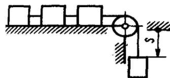
Задание 7. Два одинаковых груза массой  $1 \text{ кг}$  каждый соединены между собой нитью и движутся по горизонтальной плоскости под действием силы  $F = 40 \text{ Н}$ . Коэффициент трения скольжения тел по плоскости  $f = 0,1$ . Определить натяжение нити.
