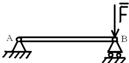
3. На балку, изображенную на рисунке, действует сила  $F$ , равная 10 кН. Чему равна реакция в шарнире А?
