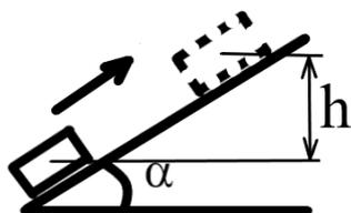
20. Сплошной однородный диск массы  $m$  и радиуса  $r$  скатывается вниз по гладкой наклонной плоскости без начальной скорости как показано на рисунке. Определить скорость центра диска в момент времени, когда пройденный путь станет равен  $s=0,3\text{ м}$ . Угол  $\alpha=30$ , ускорение свободного падения  $g=9,8\text{ м/с}^2$ .
