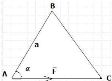
Задание 3. Определить момент силы  $F$ , приложенной к точке  $A$  треугольной пластины, относительно точки  $C$ , если  $F=7 \text{ кН}$ ,  $a=8 \text{ м}$ ,  $\alpha=30^\circ$ .
