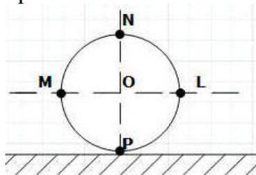
Задание 18. Колесо радиуса  $R=9m$  катится без скольжения по неподвижной прямой. Скорость центра  $v_0=5\sqrt{2} \frac{m}{c}$ . Определить скорость точки  $L$  обода колеса в данный момент времени.
