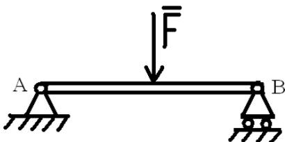
4. На балку, изображенную на рисунке, действует сила  $F$ , равная 10 кН. Чему равна реакция в шарнире В?
