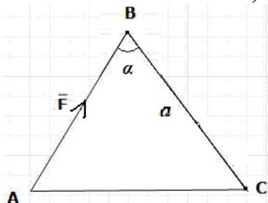
Задание 4. Определить момент силы  $F$ , приложенной к точке  $C$  треугольной пластины, относительно точки  $B$ , если  $F=3 \text{ кН}$ ,  $a=6 \text{ м}$ ,  $\alpha=30^\circ$ .
