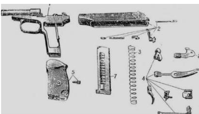
+ 1 - рамка со стволом и спусковой скобой; 2 - затвор с ударником, выбрасывателем и предохранителем; 3 - возвратная пружина; 4 - части ударно-спускового механизма; 5 - рукоятка с винтом; 6 - затворная задержка; 7 – магазин
