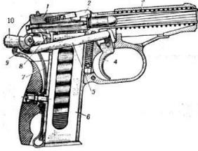
+ 1 - затвор; 2 - выбрасыватель; 3 - возвратная пружина; 4 - спусковой крючок; 5 - спусковая тяга; 6 - магазин; 7 - боевая пружина; 8 - шептало с пружиной; 9 - рычаг взвода; 10 – курок
