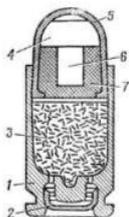
+1 - гильза; 2 - капсюль; 3 - пороховой заряд; 4 - пуля; 5 - биметаллическая (плакированная) оболочка; 6 - стальной сердечник; 7 - свинцовая рубашка
