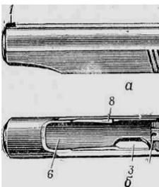
+ 1 - мушка; 3 - окно для выбрасывания гильзы (патрона); 6 - канал для помещения ствола с возвратной пружиной; 8 - зуб для постановки затвора на затворную задержку
