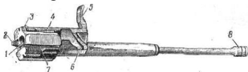
+ 1 - канал для затвора, 3 - выступ для опускания рычага автоспуска, 8 - газовый поршень, 2 - предохранительный выступ, 4 - паз для отгиба ствольной коробки , 5 - рукоятка, 6 - фигурный вырез; 7 - паз для отражательного выступа
