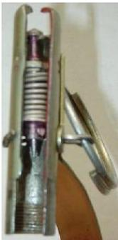
+Трубка ударного механизма
