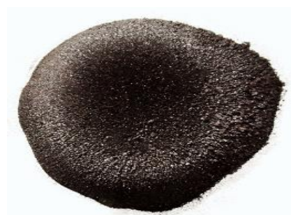
Рисунок 4 – Железная окалина (маггемит) \text{Fe}_3\text{O}_4 , обладающая магнитными свойствами
