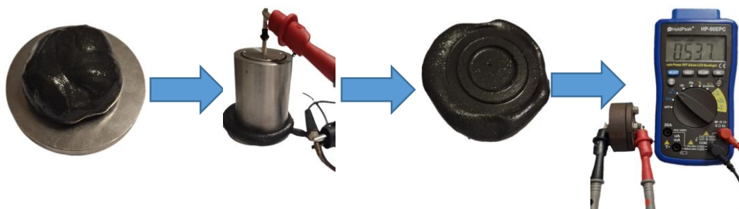
Рисунок 3 – Стадии исследования электропроводящего композита
