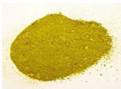
Рисунок 3 – Гидроксид железа, полученный после кислотно-щелочной обработки гальванического шлама
