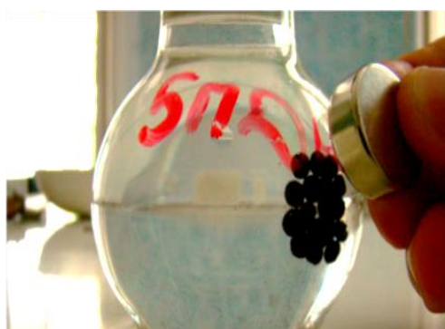
Рисунок 8 – Удаление внешним магнитным полем магнитного хитозана из очищаемых растворов
